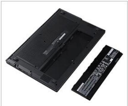
一般的なノートPCは、バッテリー交換ができないモデルが多い中、本製品はツール不要でバッテリーの取り付け・取り外しが簡単にできます。バッテリーが経年劣化・消耗した際にはご自身で交換することができ、快適なパフォーマンスを長期間にわたって維持し、安心してご利用いただけます。
